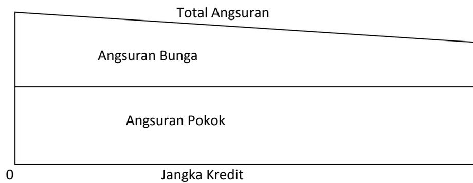
Gambar 2.3 : Angsuran total dengan bunga metode *Sliding*
